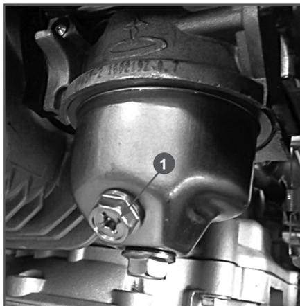
Рис. 23 Слив топлива из карбюратора
