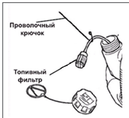
Рис. 6 Обслуживание топливного фильтра
