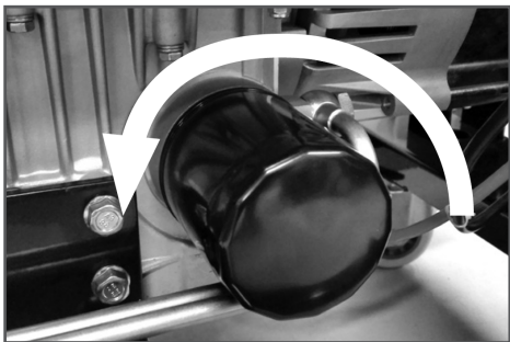
Рис. 15 Замена масляного фильтра
